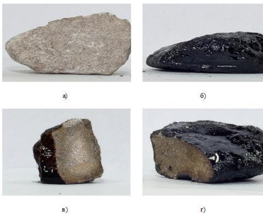
Рисунок 5 – Фотографии образцов щебня: а) исходный образец; б) внешний вид образца щебня после процесса пропитки; в) срез образца после пропитки жидким раствором деасфальтизатора в пропан-бутановой смеси в жидком состоянии; г) срез образца после пропитки раствором деасфальтизатора в СК пропан-бутановой смеси
