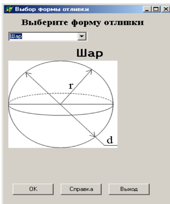
Рисунок 1 – Задание симплекс-элемента для определения конфигурации и веса отливки
