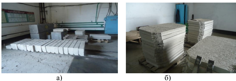
Рисунок 4 – Изготовленные железобетонные изделия: а - бордюры, б - дорожные плиты
