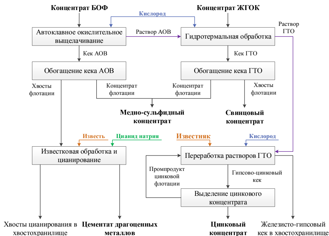
Рисунок 1 – Принципиальная технологическая схема гидрометаллургической переработки некондиционных медных концентратов
