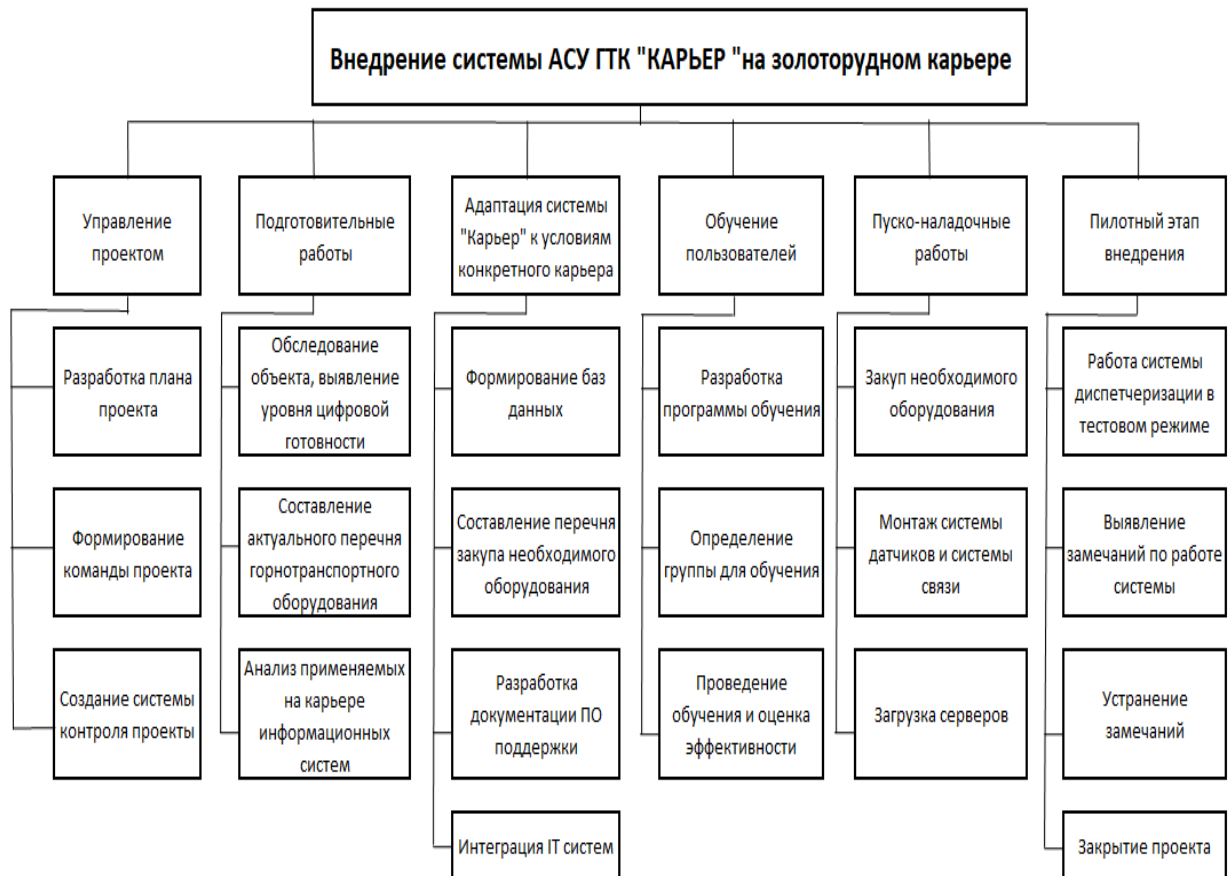
Рисунок 2 – Иерархическая структура работ по проекту внедрения системы АСУ ГТК «Карьер» на золоторудном месторождении
