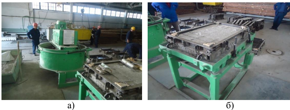
Рисунок 3 – Цех №17 по изготовлению железобетонных изделий НовоДжамбулского Фосфорного Завода ТОО «Казфосфат» г.Тараз: а - приготовление бетонной смеси б - формирования изделий
